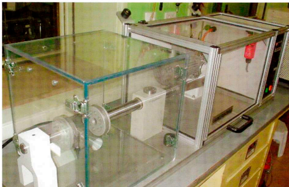
Gelbo Flex Tester. La determinació del desprendiment de partícules (Arxiu Leitat)
