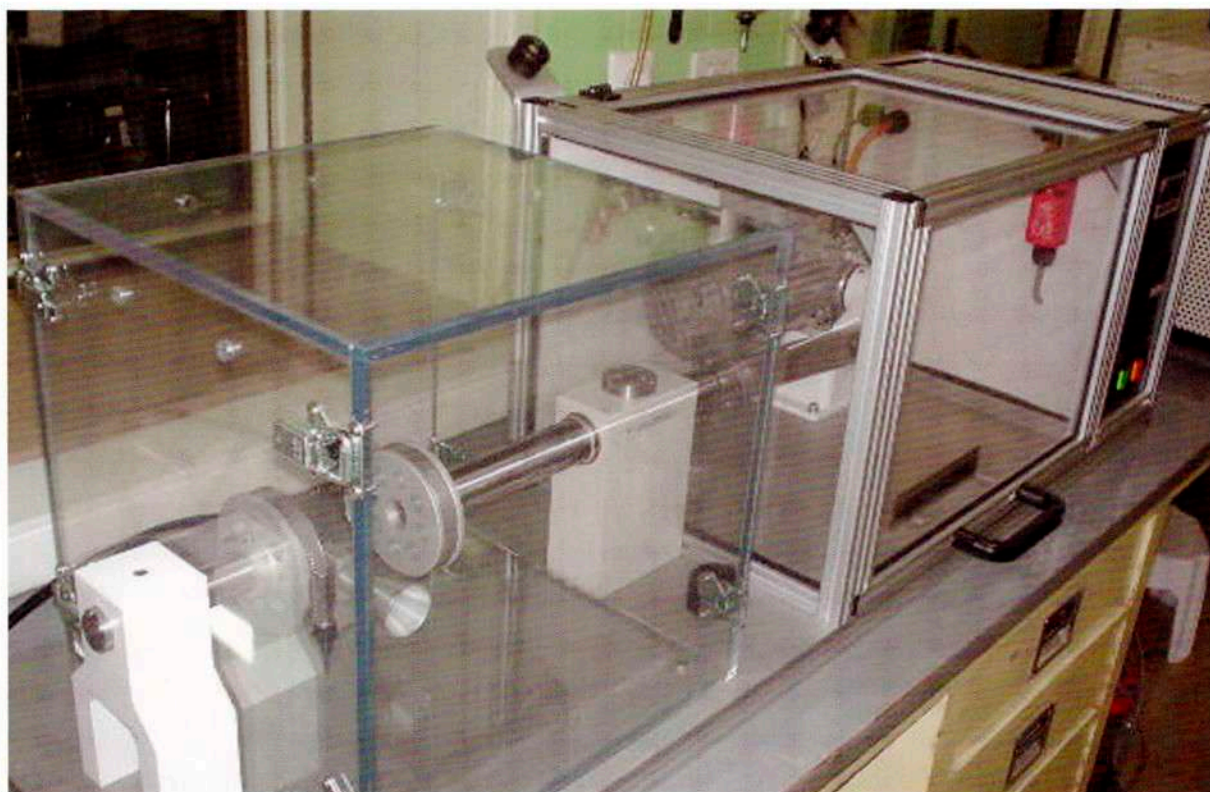
Gelbo Flex Tester. La determinación del desprendimiento de partículas (Archivo Leitat)
